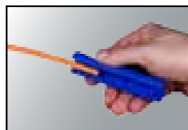
1. Kabelende auf der mit „Coat“ gekennzeichneten Seite in das Werkzeug einlegen
